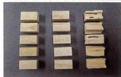
上/アメリカカンザイシロアリの食害の例。床下からだけでなく小屋裏などにも侵入して食害を起こす 下/JIS K1571:2010 附属書A(規定)の試験結果。165頭のイエシロアリに試料以外に餌がない状態で3週間摂食させる。適切にホウ酸処理された木材はほとんど食害を受けない
