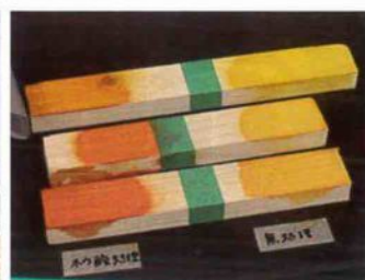
左/ホウ酸が雨で流されないようにビニールシートやブルーシートで適宜養生する 右/ホウ酸の有無を判別するには特殊なスプレーを使う。ホウ酸が存在するとオレンジに変色。検査や点検時に確認のために使用する
